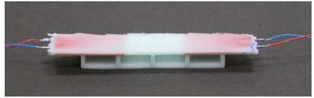
Fig. 14. Piezofilm contact sensor.
